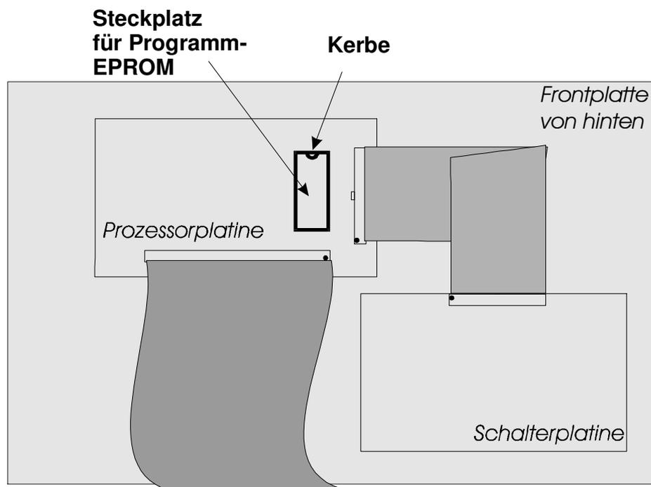
6. Setzen Sie den „neuen“ EPROM-Chip vorsichtig nach Lageplan mit der Kerbe nach oben ein und drücken Sie ihn bis zum mechanischen Anschlag auf den Stecksockel. Beachten Sie dabei, daß keine Anschluss-Pin´s verbogen werden, oder die Platine beschädigt wird.
